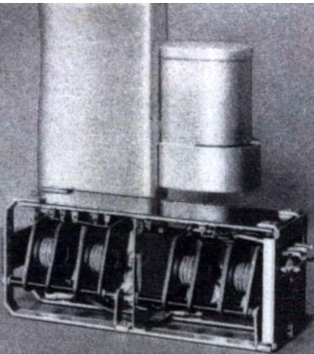
Der Zwischenfrequenz-Bandfiltersatz unseres Supers besteht aus einer viergliedrigen Filterkette. Für sämtliche Spulen wird verlustarmes HF-Eisen verwendet. Die Abgleich-Kapazitäten sind auf bestem keramischen Material aufgebaut. Das Dämpfungsmaß der Kreise beträgt ca. 0,15%.
